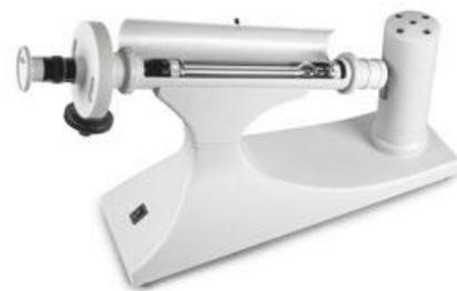
Küvette in Messkammer
