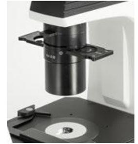
N. A. 0,3 Abbe Kondensator mit Phasenkontrastschieber
