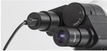
Okularkamera am Tubus befestigt
